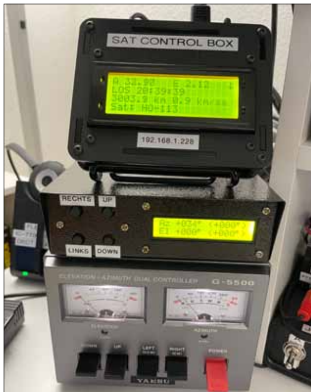
AZ- und EL-Rotor- und TRX-Steuerung mit der S.A.T. Box
