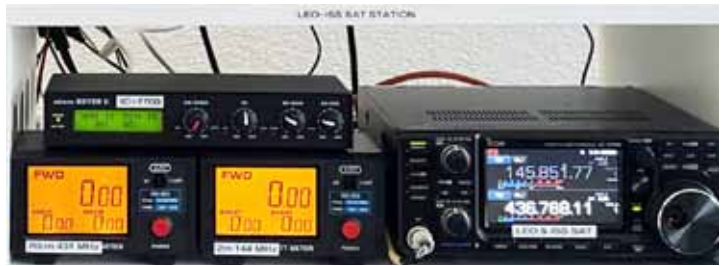
ICOM IC-9700 Transceiver mit Power-Meter
